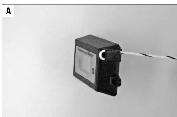
HINWEIS: Führen Sie das Fühlerkabel zur Zündspule/Zündkabel nicht umgekehrt. Führen Sie das Fühlerkabel NICHT zusammen mit anderen Kabeln oder entlang großer Metallflächen, da es die Messtätigkeit beeinflussen kann.
