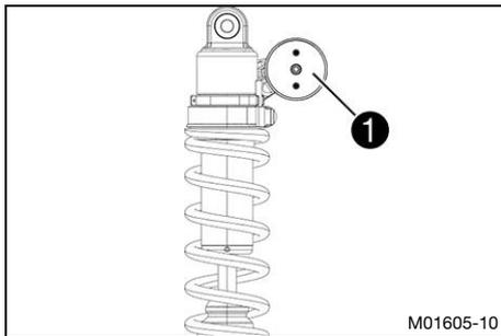
Die Federbein-Artikelnummer **1** befindet sich an der Unterseite des Ausgleichsbehälters.
