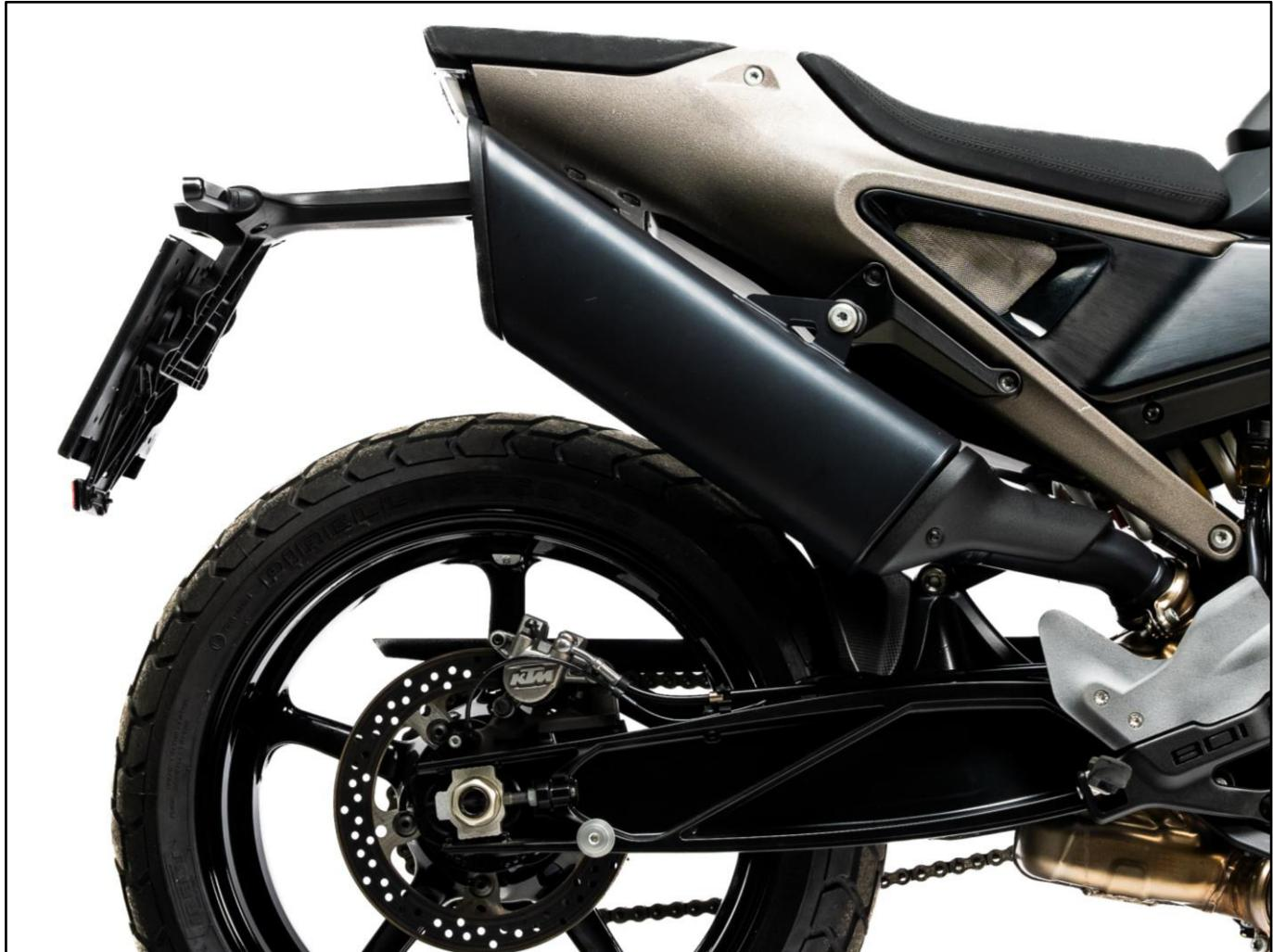
Lösen Sie die Halterschraube und Schelle des Serienschalldämpfers und nehmen Sie diesen ab.
