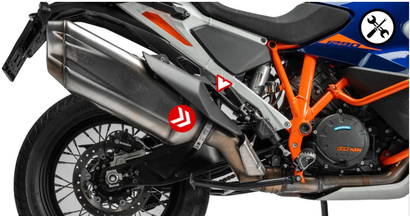
Lösen Sie die Schraube der Halterung sowie die Schelle und entfernen Sie den Serien-Schalldämpfer.
