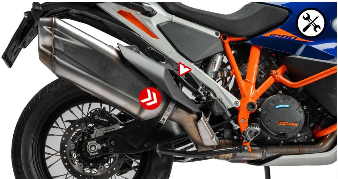
Afloje el tornillo del soporte así como la abrazadera y retire el silenciador de serie.
