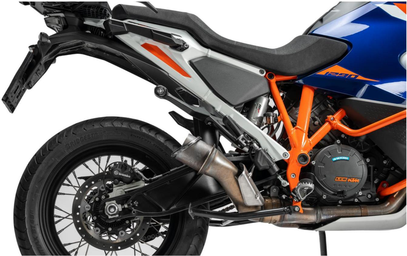
Deslice el tubo de escape deportivo REMUS sobre el cabezal de serie, utilice la abrazadera de serie y la junta.
