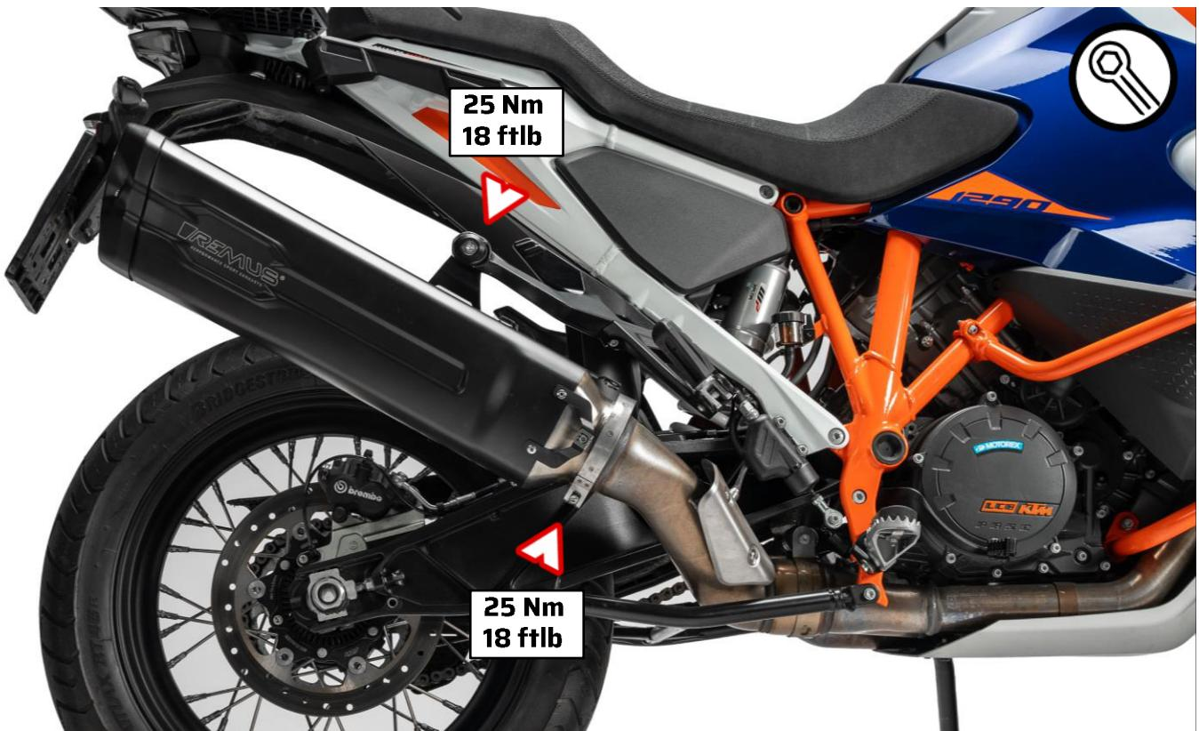
Montieren Sie die REMUS Hitzeschutzabdeckung am Schalldämpfer.
